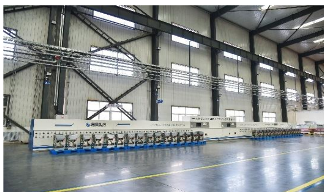
图：功率模块冷却回路密封性综合测试平台
