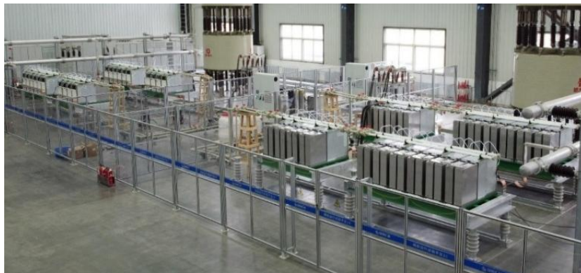
图：阀段运行试验平台
