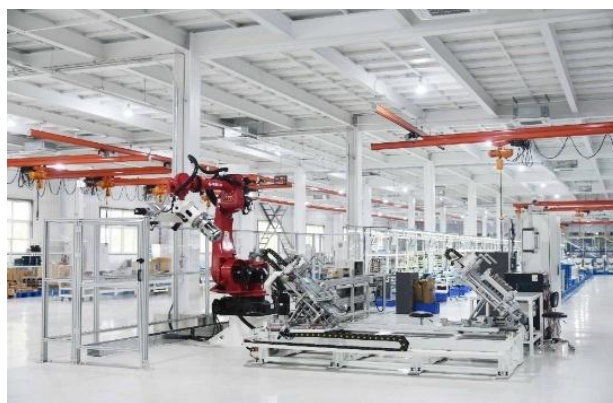
图：阀串压装机器人工作站
