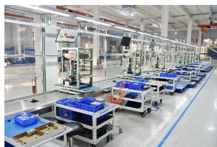
图示 2：阀串单元装配流水线
