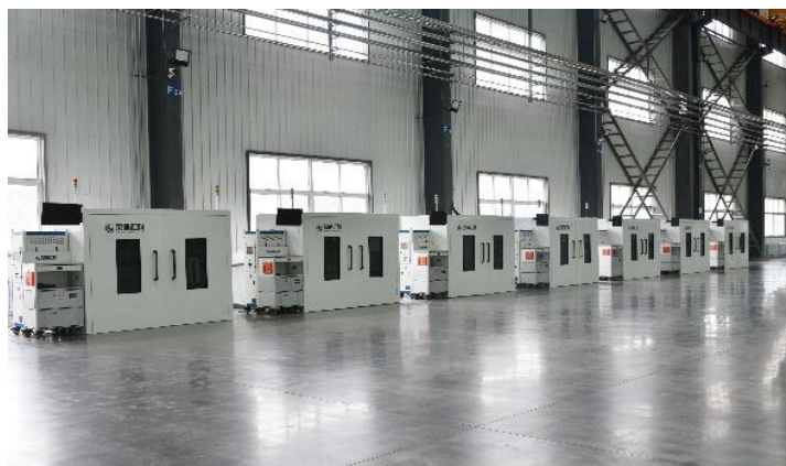
图：功率模块测试平台
