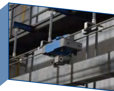
挂轨自动巡检机器人
