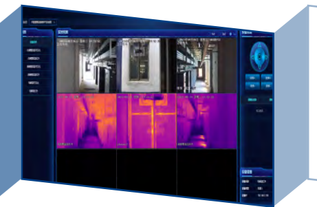
机器人巡检热成像及远程控制界面
