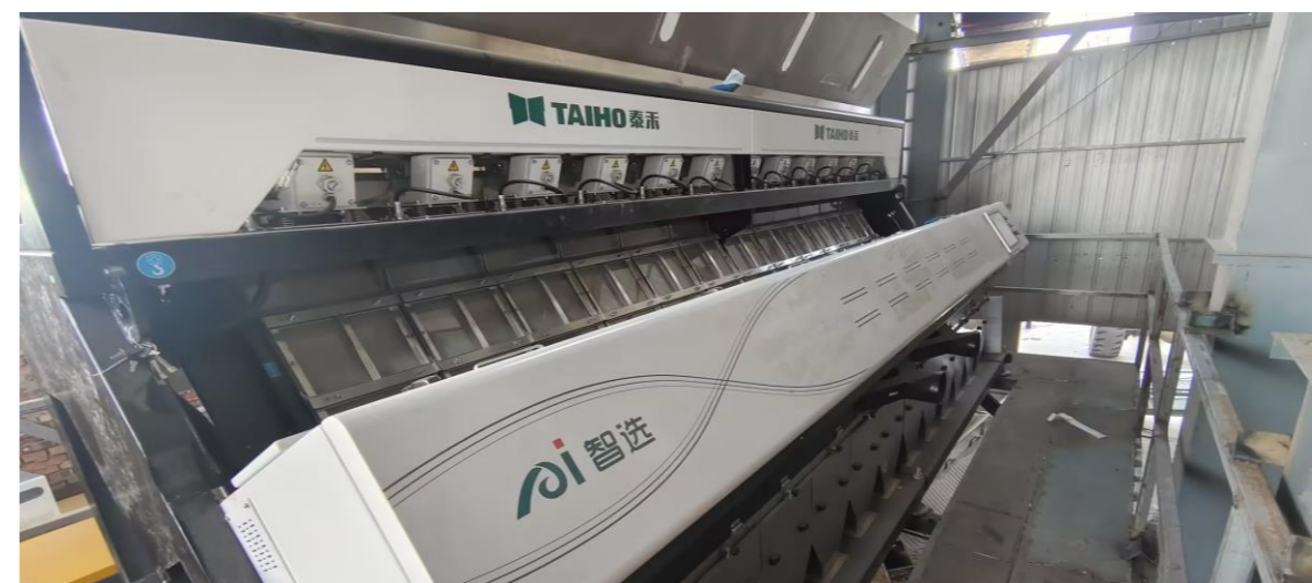
图为玉米白光紫外AI色选机在客户现场进行玉米精深加工分选作业
