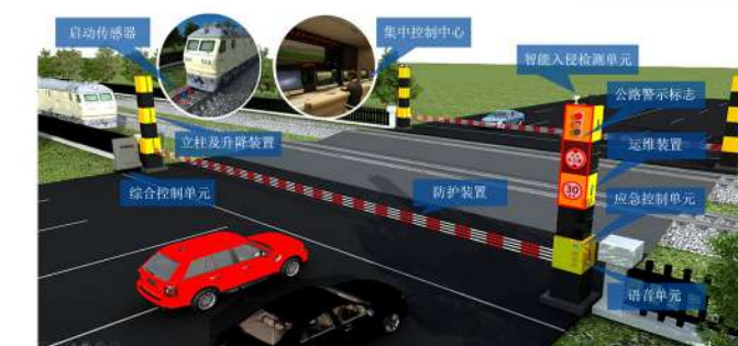
▲ 铁路货场平过道自动化安全防护系统
