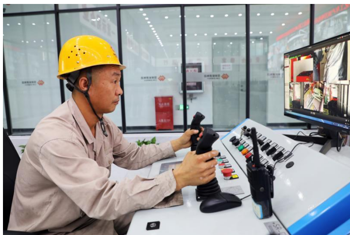
出炉工远程操纵出炉机械手
