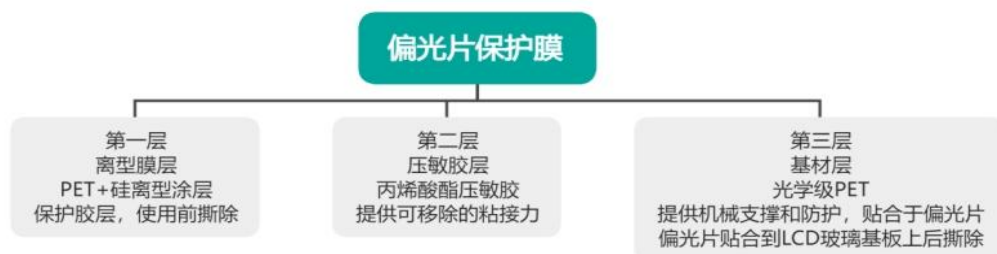
(图9 偏光片保护膜结构)
