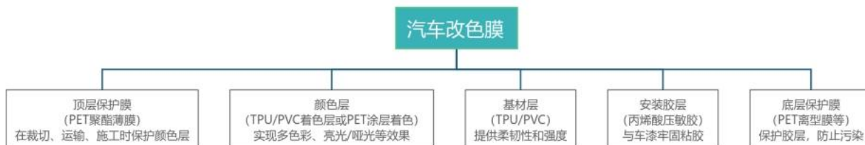
(图 13 汽车改色膜结构)
