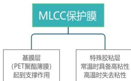
(图5 MLCC 保护膜结构)
