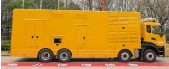
1600kW/10kV 中压电源车
