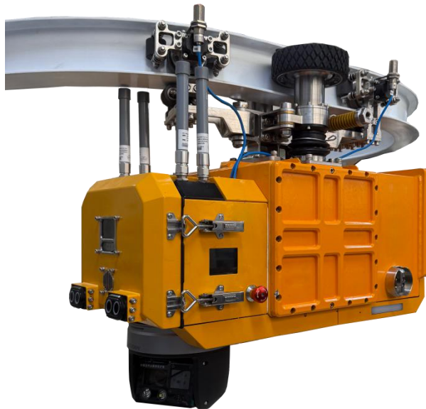
图：矿用隔爆兼本安型巡检机器人
