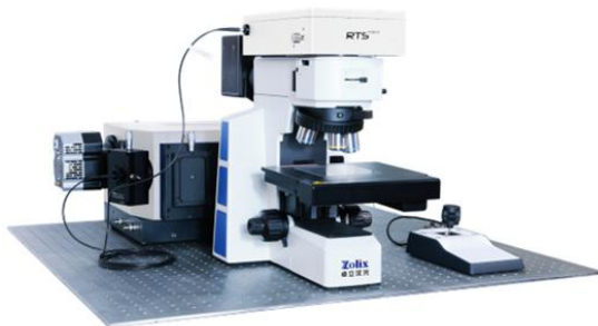
全自动显微共焦拉曼光谱分析系统
